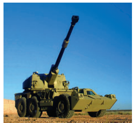
Südafrika: G6-52. Kaliber 155 mm. Rohrlänge 52 Kaliber (neueste Stufe). Gefechtsgewicht 47 t. Distanz 40 km. Feuergeschwindigkeit 4 Schuss/min. Wirkungsbereich je 40 Grad. Munitionsvorrat 48 Geschosse. Bedienung sechs Mann.
