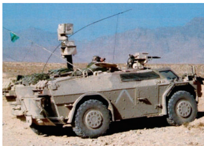
Fennek Luft/Boden, Fahrzeug für Joint Fire Support Team mit einem Fliegerleitoffizier, einem Fliegerleitunterstützungsfeldwebel, einem Fahrer. Lenkung des Feuers luftgestützter Wirkmittel für Luftnahunterstützung (Close Air Support).
