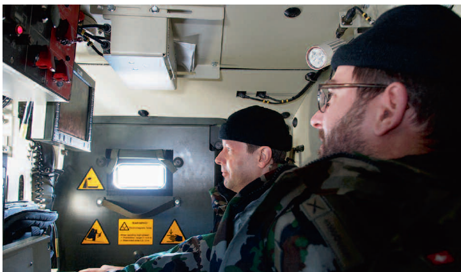
Die Feuerleitstelle befindet sich direkt auf jedem Geschütz hinter der Fahrerkabine.
