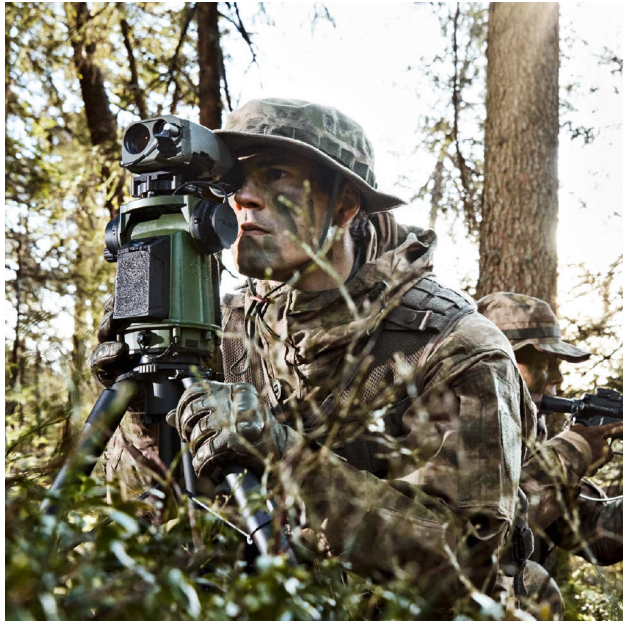
STERNA mit PLRF 25C: Zielkoordinaten CAT I (CE90) bis 1.5km bei weniger als 3kg Gesamtgewicht
