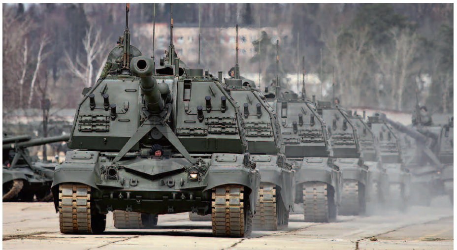
Die Standard-Panzerhaubitze 2S19 Msta-S, mit einer Kadenz von acht Schuss/Minute.
